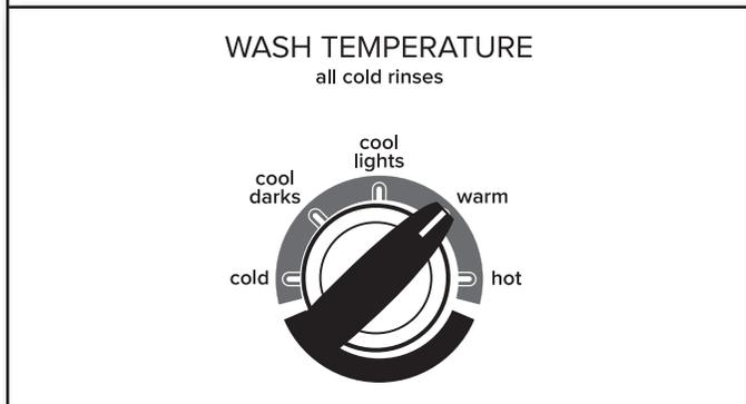
Après avoir sélectionné un programme, sélectionner la température de lavage désirée en tournant le bouton Wash Temperature (température de lavage).
